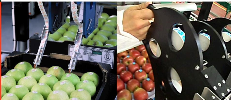
Le **BCS** est une machine conçue exclusivement pour l'étiquetage des fruits dans les alvéoles 50 x 30 et 60 x 40 avec un seul passage sous l'étiqueteuse, dans le sens 40 (ou 30) de préférence. C'est le système le plus économique et le plus simple d'utilisation.
